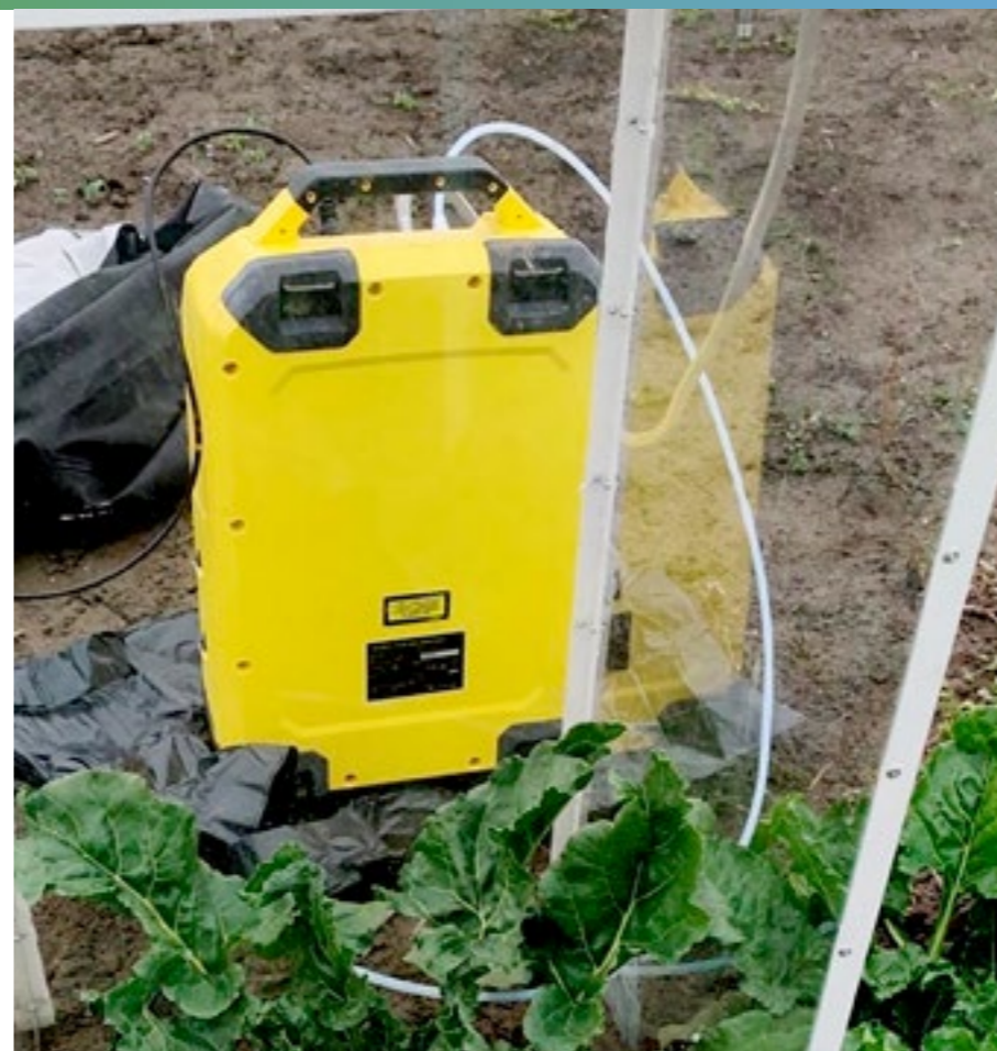
Kaasumittarilla tutkitaan juurikkaan hiilensidontaa ja hengitystä.
